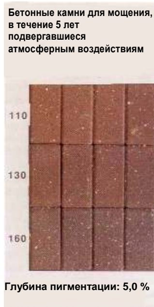
Рис. 12. Бетонные камни для мощения, в течение 5 лет подвергавшиеся атмосферным воздействиям
