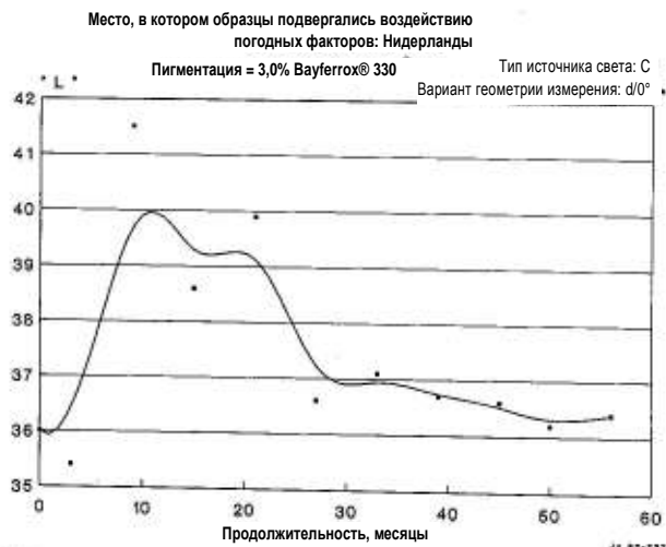
Рис. 13. Протекание процесса образования налета на бетонной черепице
