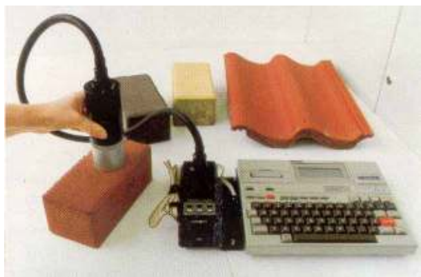
Рис. 7. Фотометр с тремя фильтрами, с разделением измерительной части и компьютера
