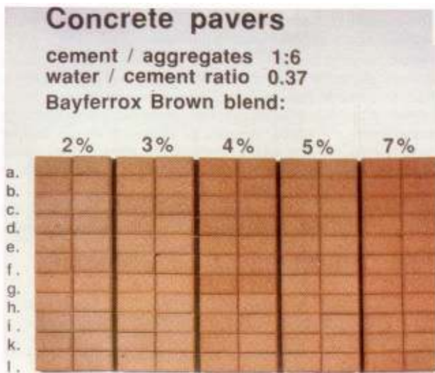
Рис. 17. Бетонный камень-брусчатка, изготовленный с различным количеством пигмента (2-7%) и различными ошибками (a-l) дозировки компонентов
