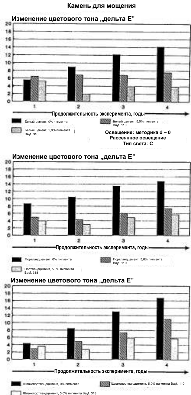
Рис. 16. Изменение цветового тона под воздействием атмосферных факторов
